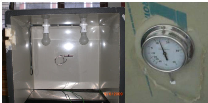
Gambar 6. Ruang pendingin ( cold box ) dengan alat ukur temperatur
